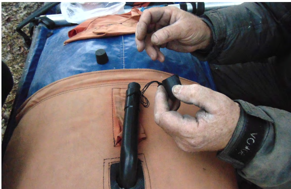
Фото 02.05. На Судне-1 прочно привязываем капроновыми нитками затычки штуцеров
